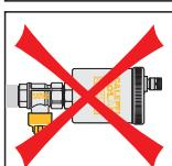
Le valvole automatiche di sfogo aria serie 250 devono essere installate in posizione verticale, tipicamente sulla sommità dei pannelli degli impianti solari e nei punti del circuito dove si raccolgono le bolle d'aria che devono essere scaricate.
